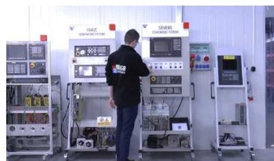
Wir verfügen über von uns entwickelte Prüfstände, mit denen wir prüfen, ob das Gerät funktionsfähig ist. Sie sorgen dafür, dass BOSCH REXROTH DKC03.3-016-7-FW repariert wird.
